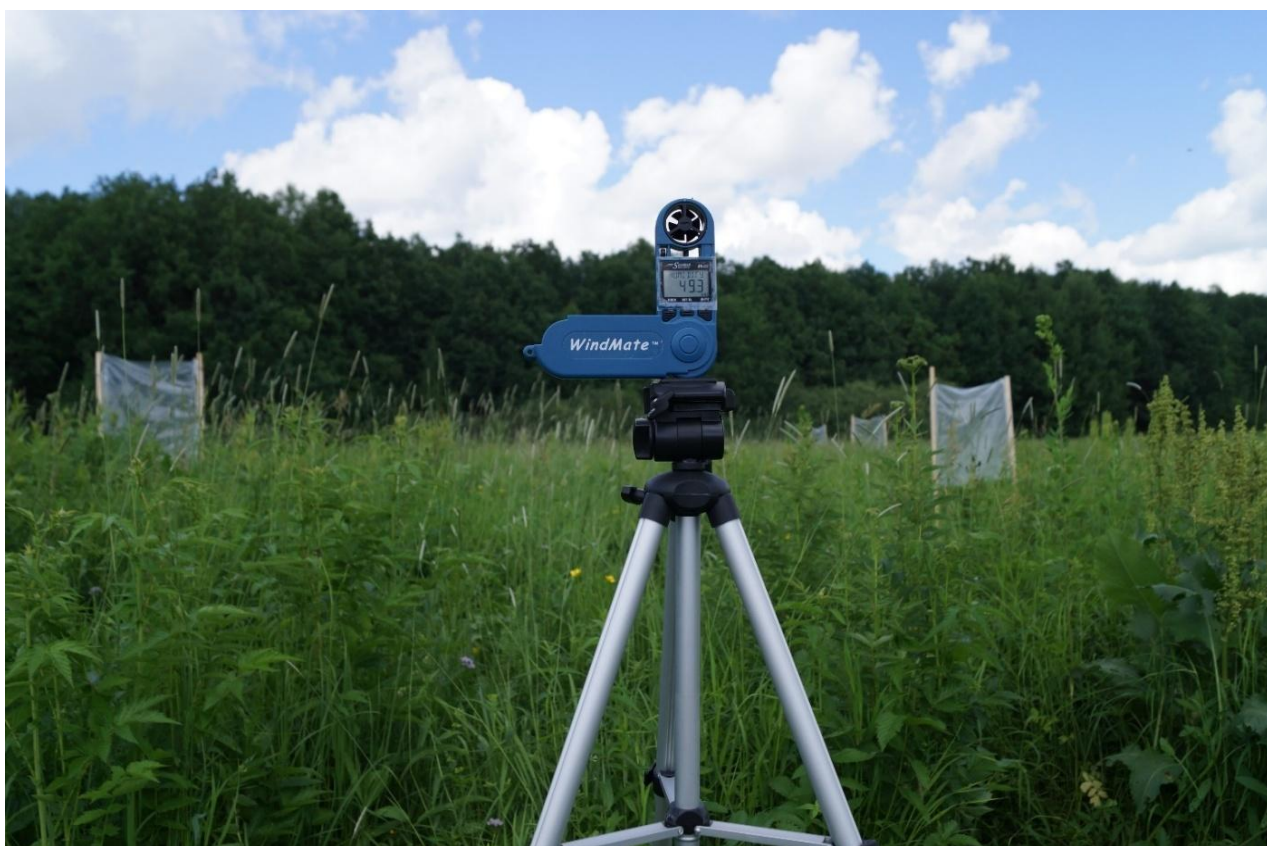
Рисунок 2.22. Измерение погоды с помощью портативной метеостанции WindMate 300 (фото И.В. Ермолаев)
